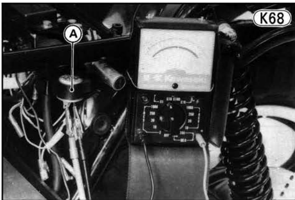
A. Hazard Relay
