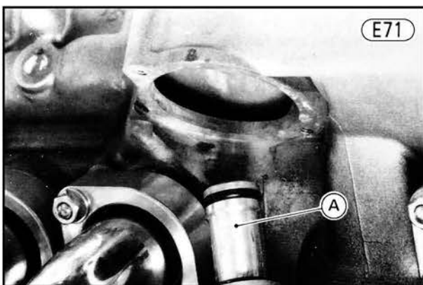
A. Bypass Pipe
